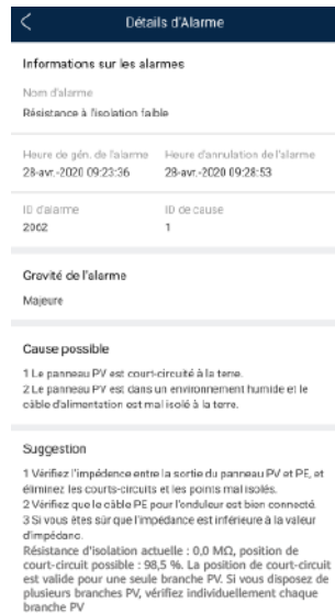
Figure E-1 Détails d'alarme
