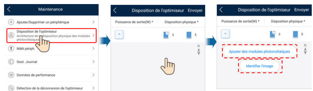
Figure 7-7 Disposition physique des modules PV
